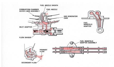
**DUAL ORIFICE FUEL NOZZLES**
