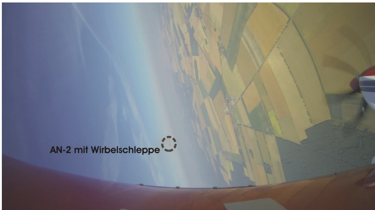
Dokumentierte Auslenkung um die Längsachse um mehr als 90°
